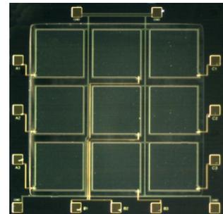
Fig. 3: 3x3 Sensor array
