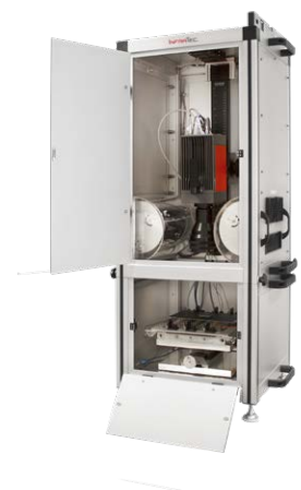
Kontaktlose und kontaktierte Anregung in Messzelle (LimoLIT/VomoLIT)
