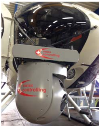
Helicopter mit montierter VarioCAM® High Definition im Gimbal
